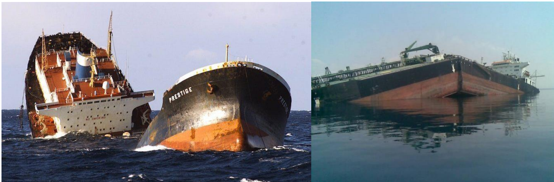
Gambar 2. Patahnya konstruksi kapal tanker akibat beban berlebih.
